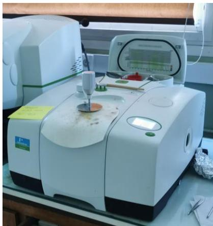
Figure 7 : Spectrophotomètre infrarouge
