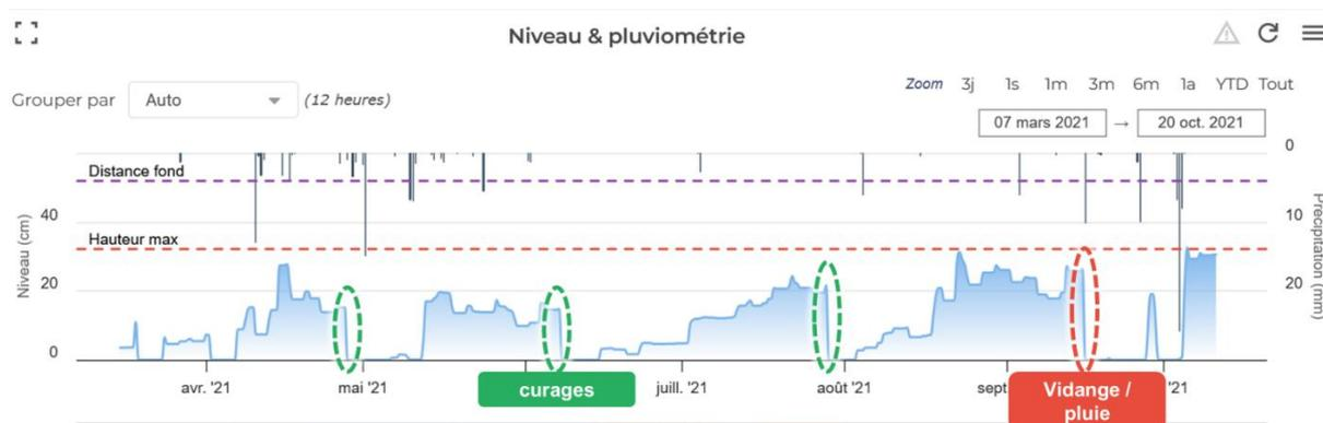
Figure 10 Aperçu de l'application montrant l'évolution du remplissage d'un avaloir à Marseille. En vert : les opérations de curage, en rouge : une vidange liée à un épisode pluvieux (source : GreenCityZen).
