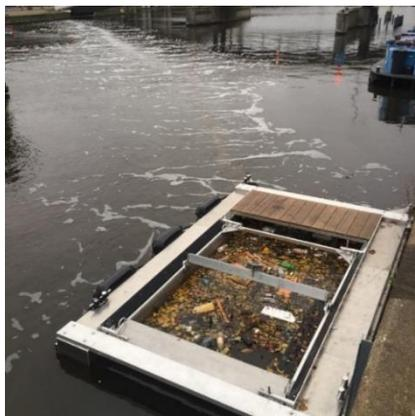
*Figure 2 Vue du rideau de bulles déviateur, en surface de l'eau, et du piège flottant (Source : The Great Bubble Barrier)*
