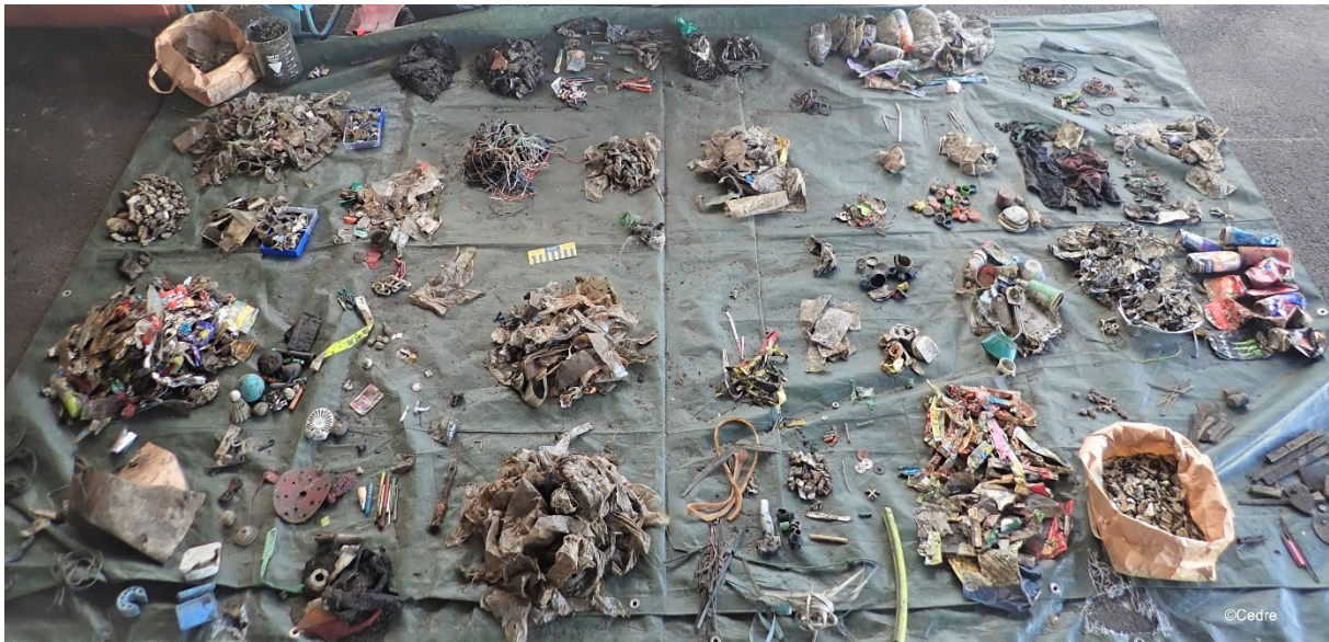
Figure 8 : Caractérisation des macrodéchets interceptés par un filet de rétention installé sur un exutoire d'eau pluviale du bassin versant du Sprenot, territoire de Brest Métropole (©Cedre)
