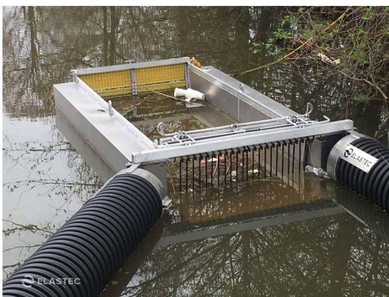
Figure 3. Collecte de macrodéchets flottants par le dispositif Brute Bin . (Crédit photo : Elastec).
