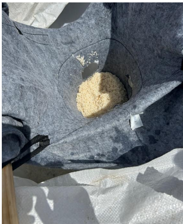
Figure 2. Collecte de GPI par le filtre Ultra-drain guard d'Ultratech International Inc. (Crédit photo : CEDRE).
