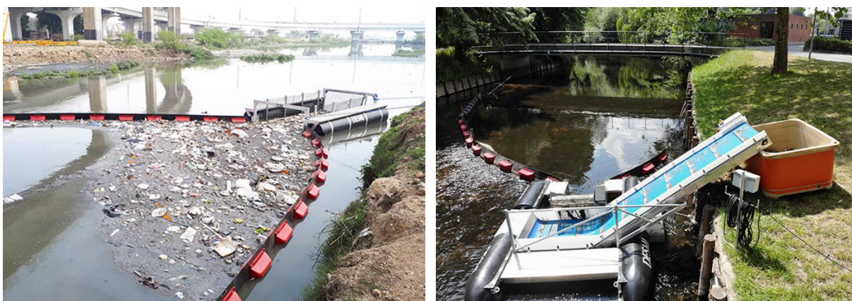
Figure 4. Collecte de macrodéchets flottants par les dispositifs Enhancer (gauche) et Rise (droite) de la gamme EnviRo Care de Desmi. (Crédits photos : Desmi).
